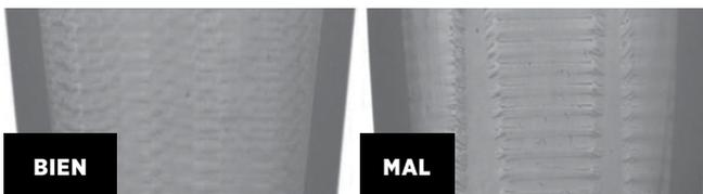
Corte del tubo PEX después de una expansión adecuada e inadecuada
