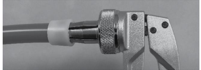
4. Deslice la tubería/aro por el extremo estrecho del cabezal de expansión todo lo que se pueda sin forzarlo. Expanda la tubería/aro cerrando las manijas de la herramienta. Libere las manijas y deje que el cabezal se contraiga. Gire la herramienta 1/8 de vuelta, empuje la tubería/aro más adentro del cabezal de expansión y vuelva a expandir cerrando las manijas.
